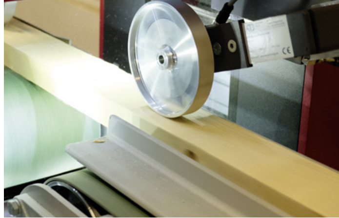
Der Kappscanner ATB Spectra schafft bis zu 200 m/min Vorschub
